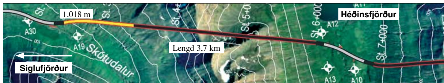
Staða framkvæmda við Héðinsfjarðargöng 5. mar 2007. Búið er að sprengja 1.018 m í Siglufirði og 805 m í Ólafsfirði.
